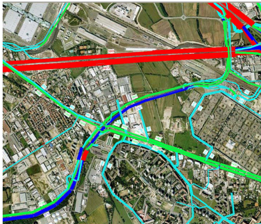
Figura 7.3-15: flussi ora di punta del mattino – scenario 2015 senza Cascina Merlata – dettaglio area di studio
