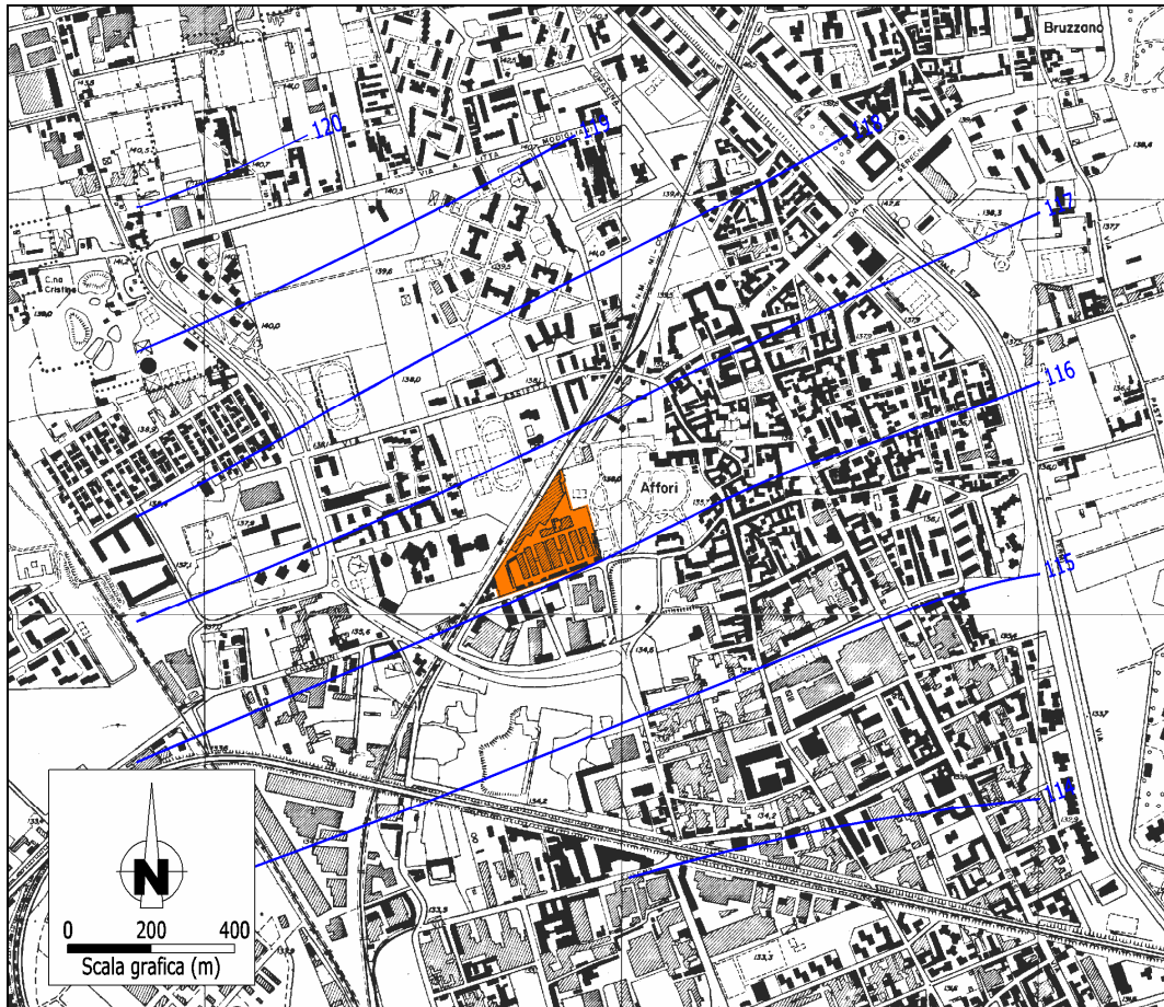
Figura 40: Stralcio della Carta delle isofreatiche di dettaglio (derivata da dati SIA della Provincia di Milano + dati piezometri area ex Luceplan) aprile 2012.
