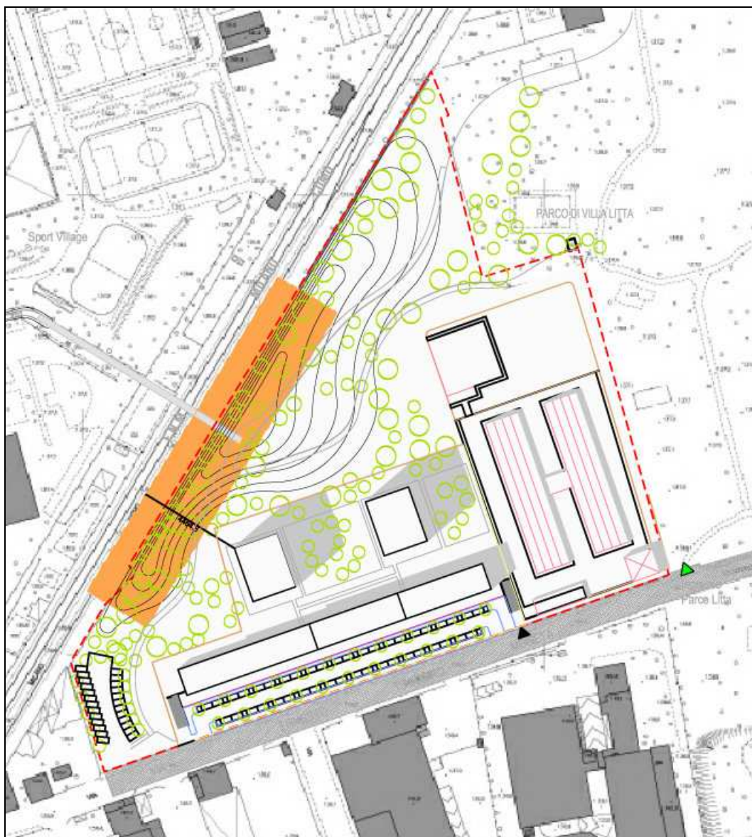
Figura 31: Fascia di rispetto ferroviario (Art. 46 DPR 11/07/1980 n. 753).
