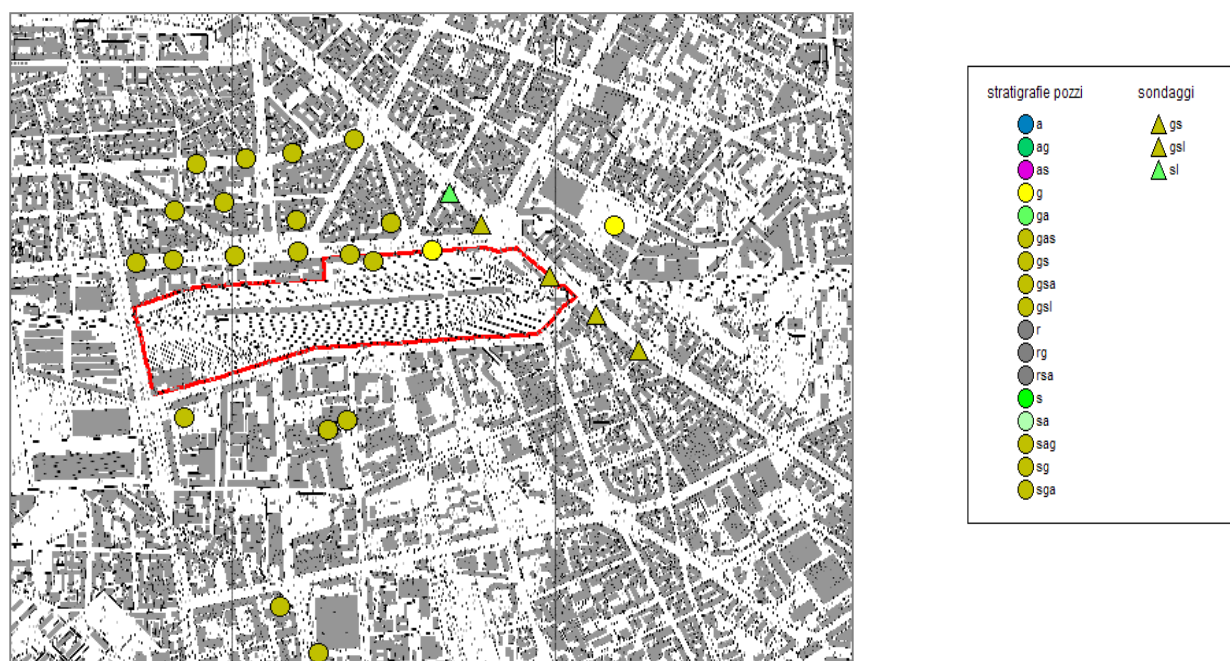
Fig. 2.8: granulometria dei primi 10 m e relativa legenda (Sigle legenda: g: ghiaia s: sabbia a: argilla l: limo r: materiale di riporto, riempimenti)
