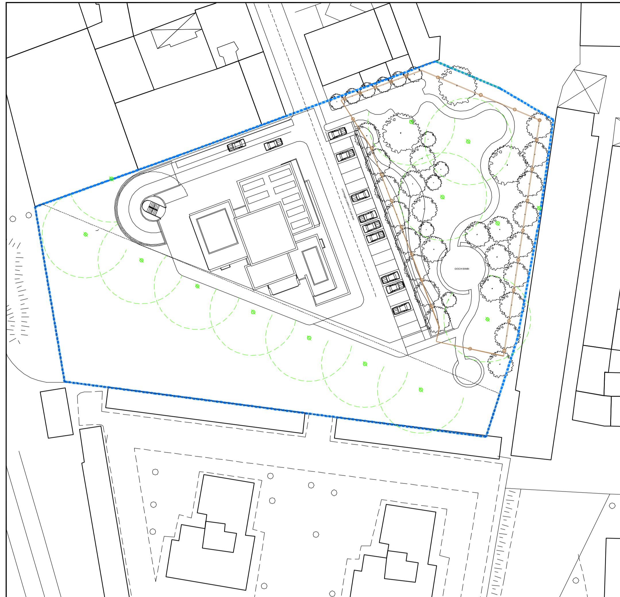
PLANIMETRIA DI PROGETTO - SCALA 1:500 SISTEMI DI IRRIGAZIONE
