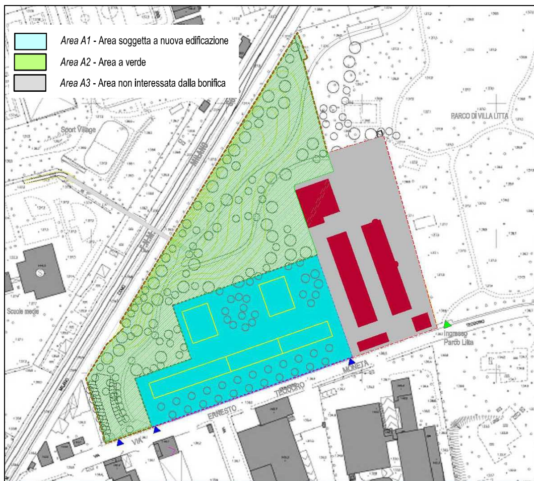
Figura 7: Suddivisione del sito a seguito degli interventi di riqualificazione edilizia.
