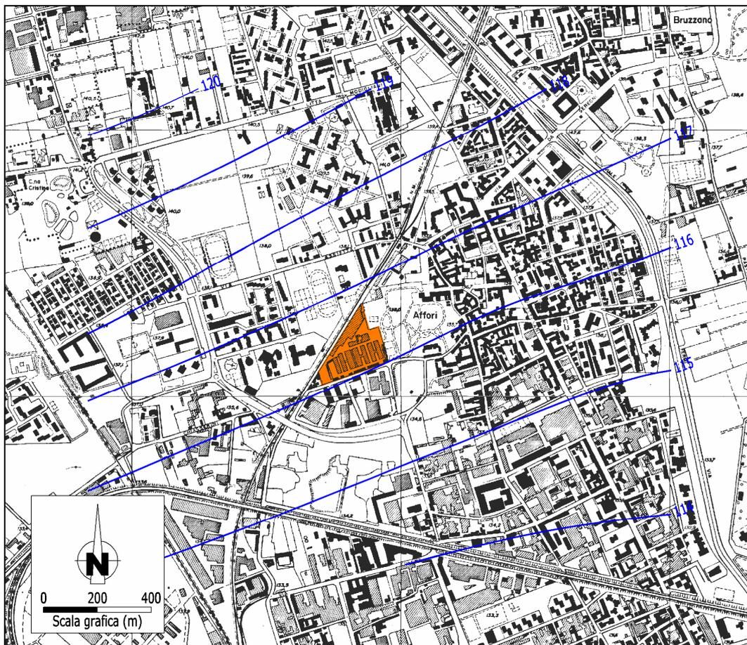
Figura 46: Stralcio della Carta delle isofreatiche di dettaglio (derivata da dati SIA della Provincia di Milano + dati piezometri area ex Luceplan) aprile 2012.
